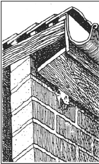
Abb. 27: Einflug über Spalten am Dachkasten 7
