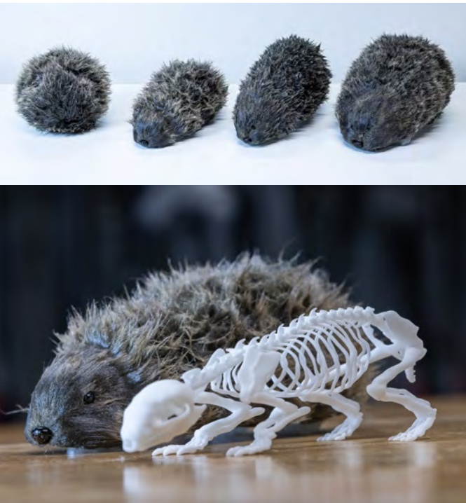
Abb. 2 und 3: Von der crashtest-service.com GmbH entwickelte Igelattrappen für die Verwendung in späteren, standardisierten Mähroboter-Sicherheitstests (Quelle CTS GmbH).
