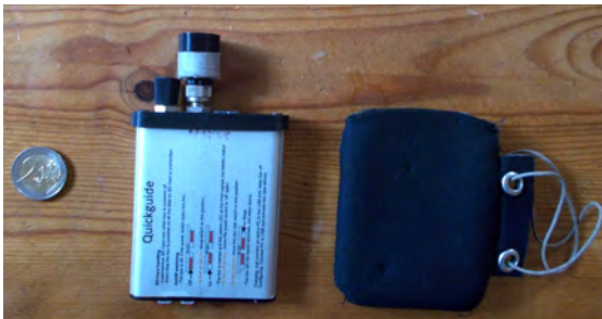
Abb. 1: Horchbox der Firma Albotronic/Oberkochen mit Neoprenschutzhülle und Münze zum Größenvergleich
