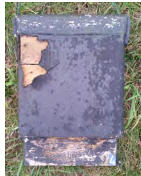
Abb.1. F1 Kasten mit aufgerissener Dachpappe
